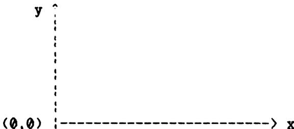
Le dimensioni della finestra determinano la larghezza massima rappresentabile, mantenendo l'unita' di misura lungo l'asse delle x uguale a quella lungo l'asse delle y.
